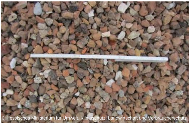
Abbildung 2: Recyclingbaustoff (Korngröße 0 - 45 mm)
